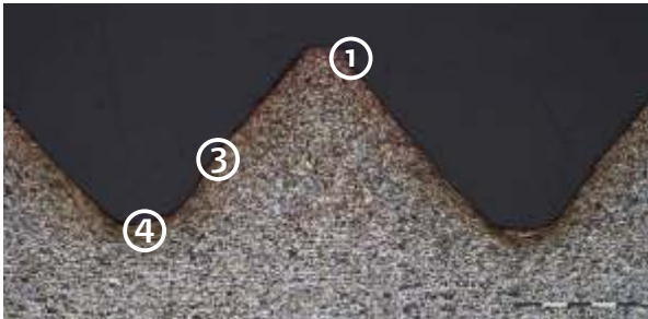
Abb. 1: Mikroschliff eines mit N16 gerollten Gewindes / micro-section of with N16 hand-rolled thread
